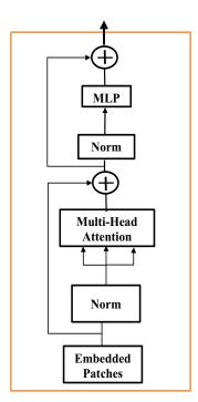
Fig. (1). Transformer encoder.
